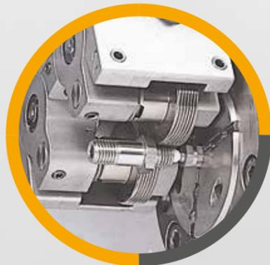
Mit dem WAGNER Tangential-Rollsystem werden Gewinde höchster Qualität und Oberflächengüte bei kürzesten Bearbeitungszeiten erzeugt.
